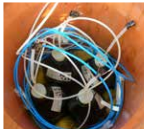
Saugkerze mit Ansaugröhrchen und Sammelflaschen für Sickerwasser
