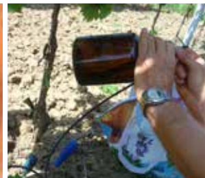
Saugkerze mit Ansaugröhrchen und Sammelflaschen für Sickerwasser
